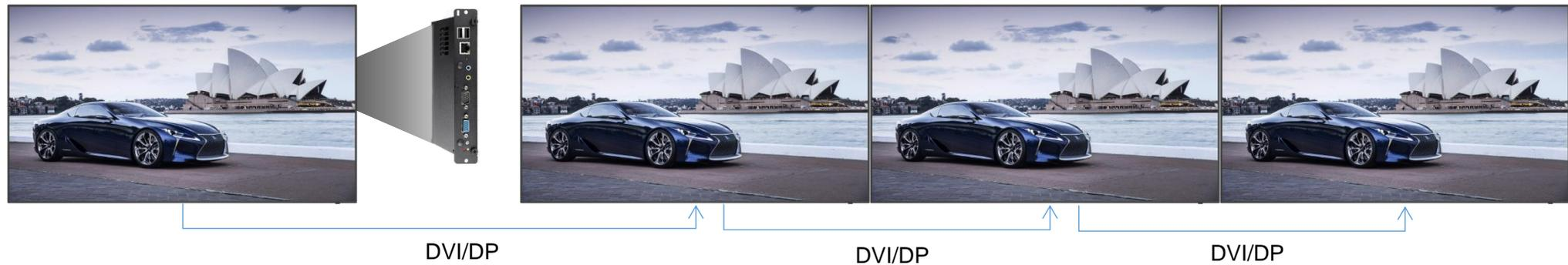
***Prise en charge de la fonction de boucle par connexion câble DVI ou DP (jusqu'à 12 appareils maximum)***
