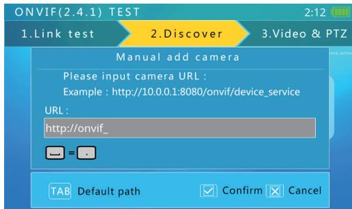
Pour ajouter manuellement une caméra, il faut connaître l'IP exacte de la caméra et le chemin de service ONVIF.
