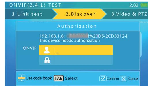
Après avoir terminé le paramétrage, appuyez sur la touche **[+]** pour confirmer. Le testeur enverra les nouveaux paramètres à la caméra. Si la caméra accepte les nouveaux paramètres, le signal d'avertissement de paramétrage réussi apparaîtra. Sinon, des informations relatives à l'échec de paramétrage apparaîtront.
