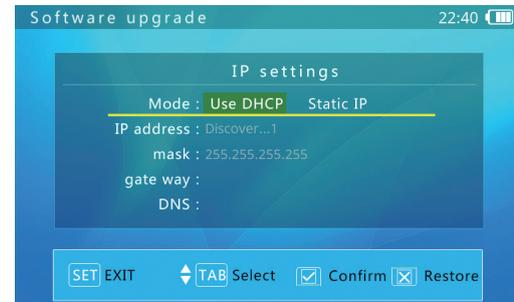
Si le réseau utilise DHCP, le testeur détectera automatiquement les paramètres IP. Sinon, les paramètres IP devraient être entrés par l'utilisateur. Veuillez consulter votre gestionnaire de réseau.
