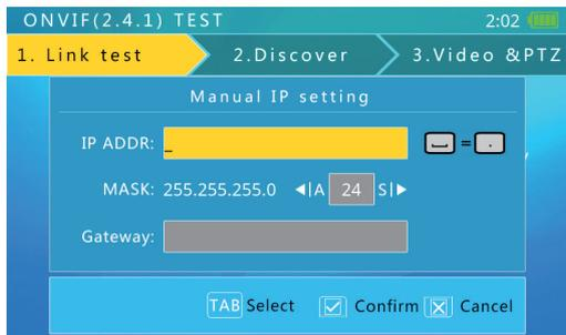
Veuillez utiliser le clavier de basculement pour saisir l'IP et utiliser la clé A/S pour ajuster le masque. Pour accéder à Internet, un accès à la passerelle est également nécessaire.
