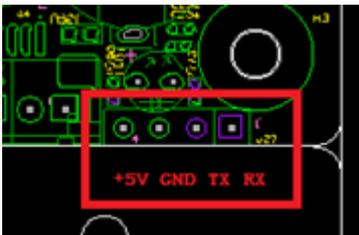
串口位置为左边圆圈的，需要排针或者白座子连接。排针料号没有，有白座子料号 1.2.17.12.0009。
