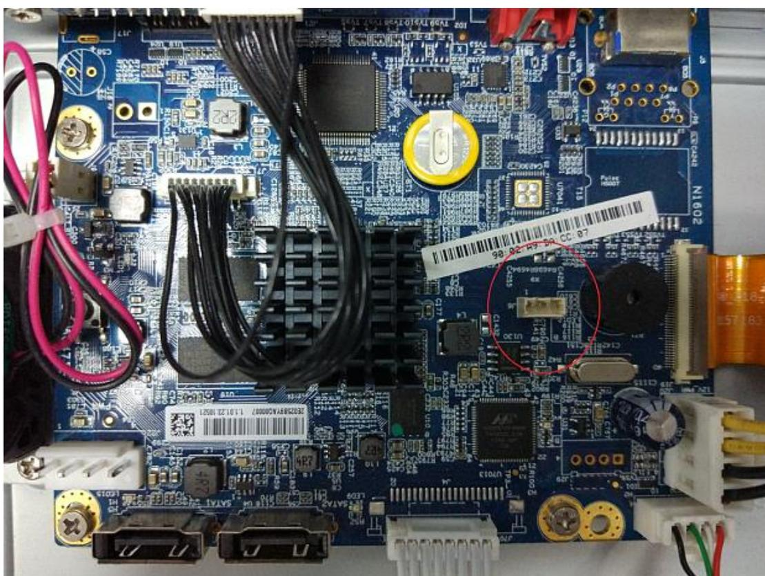
NVR4-4KS2 串口输出引脚为红色圈部分
