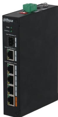
Le DH-PFS3106-4ET-60 est un commutateur PoE de couche d'accès qui prend en charge l'accès simultané à un maximum de quatre caméras. Il convient aux scènes de surveillance extérieures telles que les sites pittoresques, les embranchements routiers, les mines de charbon et les postes électriques.
