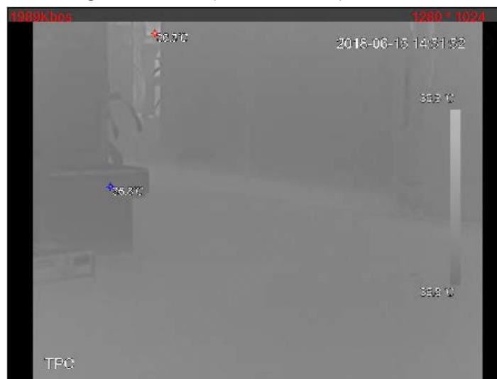
Figure 12 - Exemple de suivi de point chaud
