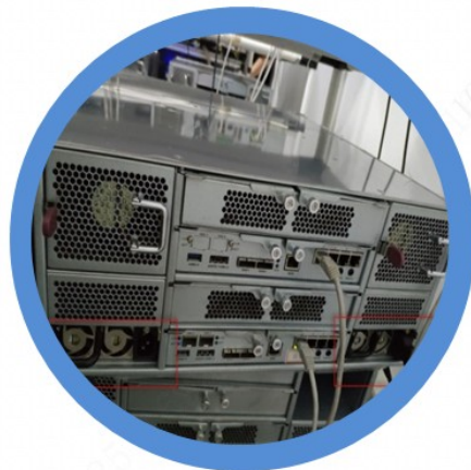
Figure 4-4 Technologie à double alimentation de secours
