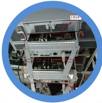
Figure 4-3 Technologie à double contrôleur
