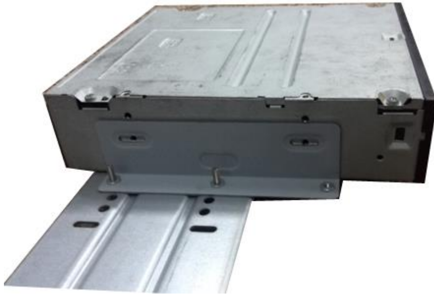
Figure 3-43 Installation d'un graveur SATA
