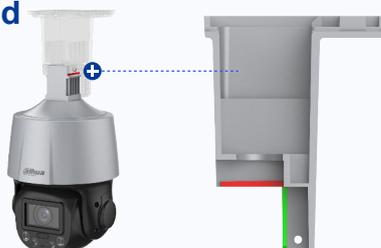
Insérez la barre de guidage rouge dans le guide de la caméra et serrez les vis.
