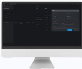
La configuration du système back-end est directe pour les enregistreurs NVR et XVR. Il suffit de configurer le protocole HTTP au niveau du centre des alarmes et de choisir les types d'événements ou d'images.
