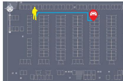
Le localisateur de véhicule équipé d'un écran tactile permet de trouver facilement votre voiture. Recherche approximative de plaque d'immatriculation/heure d'entrée/photo, confirme avec l'image du véhicule, puis indique la place de stationnement. En outre, il peut indiquer le meilleur chemin pour aller du kiosque à la place de stationnement de votre voiture.
