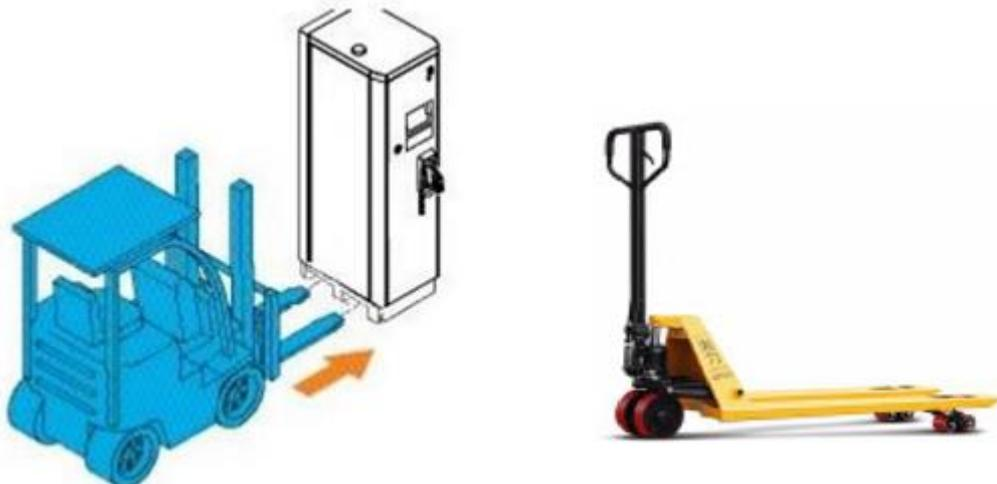
Étape 1 : Déplacez les fourches du chariot élévateur dans les espaces situés sur le côté du chargeur de VE.
