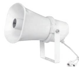
Puissance nominale : 15 W | Mode d'alimentation : PoE (IEEE 802.3at) / 24 V CC 2 A (veille) | Catégorie d'étanchéité : IP66 | Matériau : Aluminium de qualité aéronautique | Stockage : 512 Mo (extensible)
